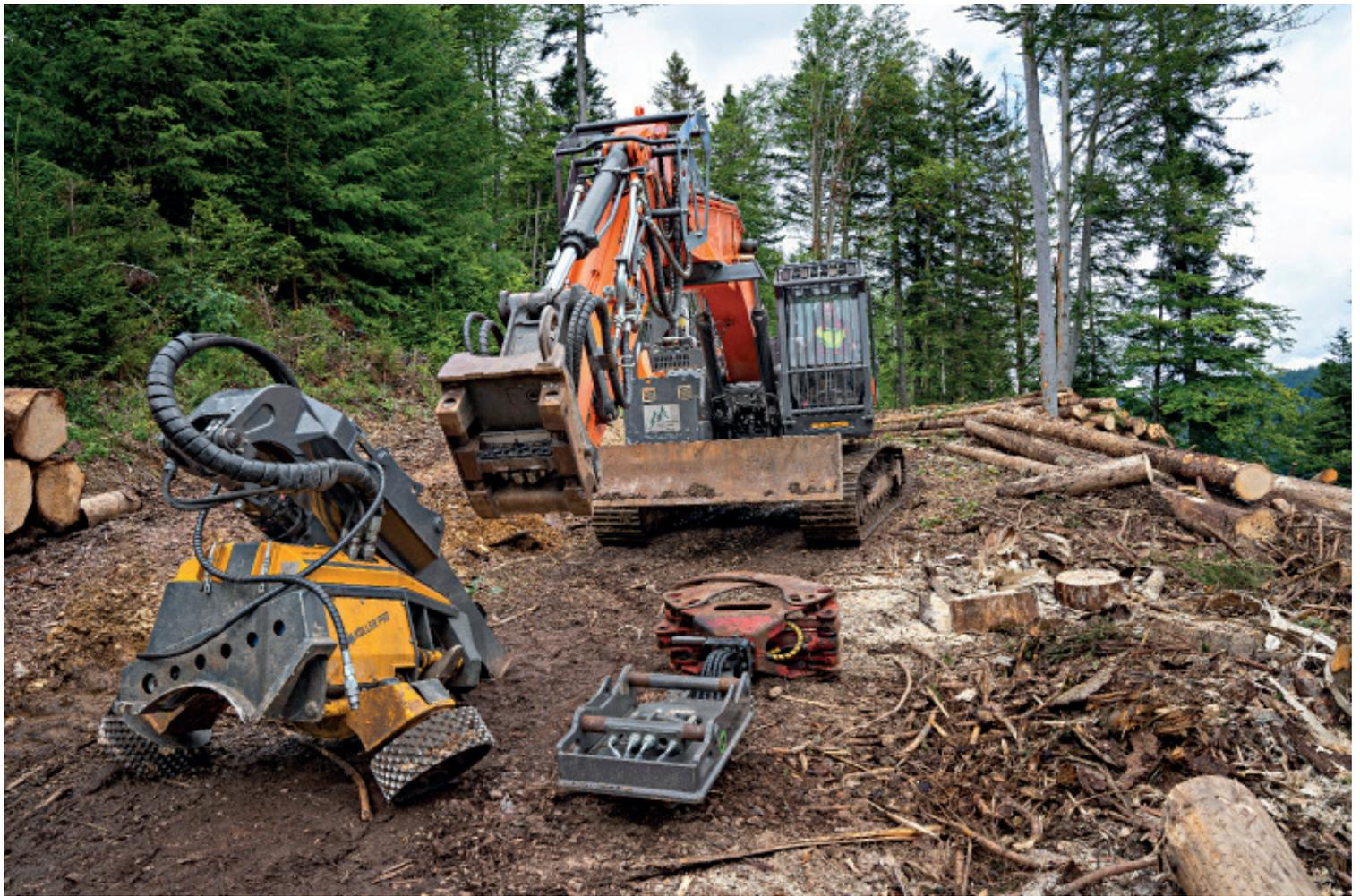
Mit dem Oilquick-Schnellwechsler ist das Aggregat innerhalb weniger Minuten gegen einen Greifer oder Löffel ausgetauscht. Es ist auch praktisch, wenn man den Prozessorkopf separat auf einem Anhänger transportieren kann
