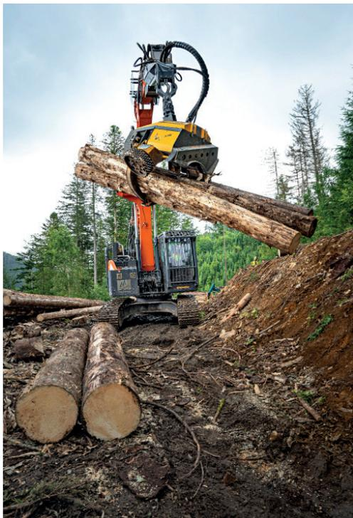
Der Koller P 60 besitzt separate Greifarme. Das mindert den Verschleiß an den Entastungsmessern
