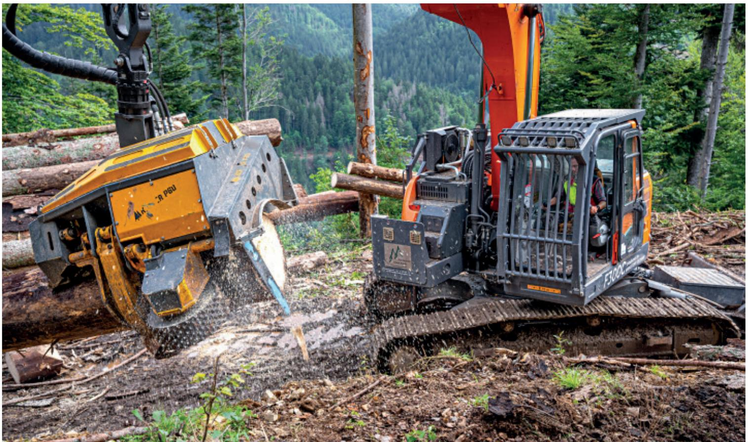
Der Koller-Prozessor besitzt keinen Endlos-Rotator. Der würde die Ölleistung zu sehr begrenzen, sagen die Konstrukteure
