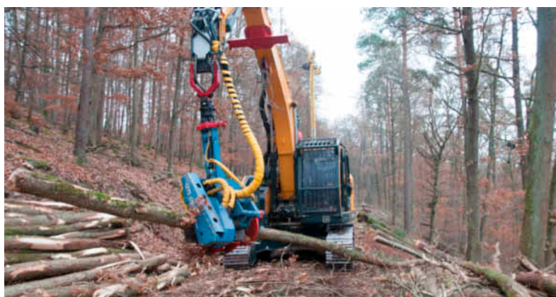
Der Kettenbagger greift mit seinem Prozessorkopf die Stämme, sägt sie auf die richtige Länge und legt sie für den Weitertransport am Wegrand ab.
