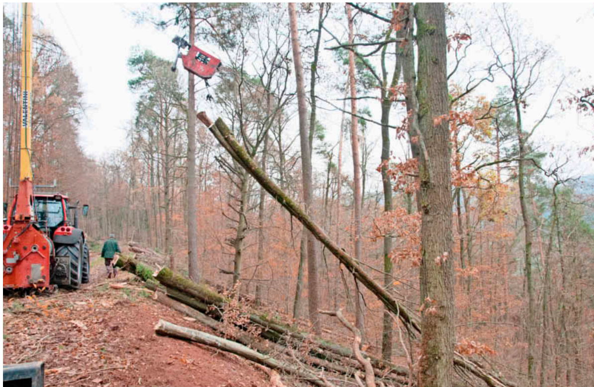
Der Turm mit Seilkran fördert das Stammholz bis zum Waldweg und legt es dort ab.
